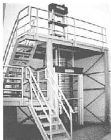
Máquina patrón de carga directa para 100 kN
